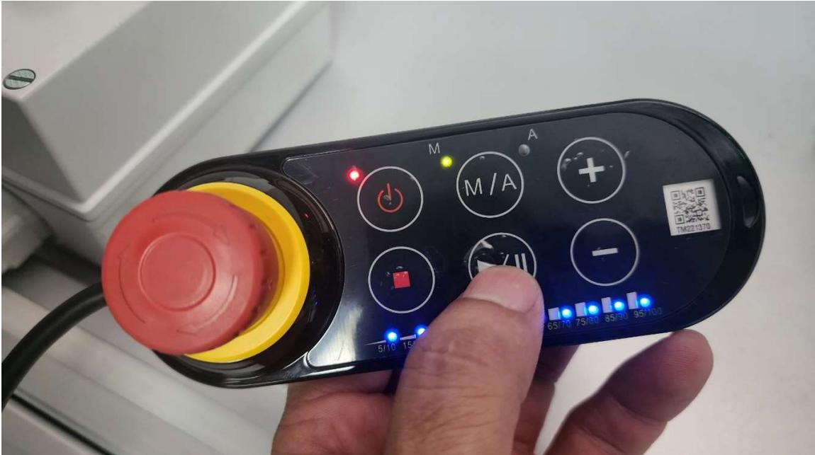
Sonará un pitido antes de iniciar el movimiento del robot. Puede subir y bajar la velocidad con las tecla “+” y “-” del control colgante del robot.
