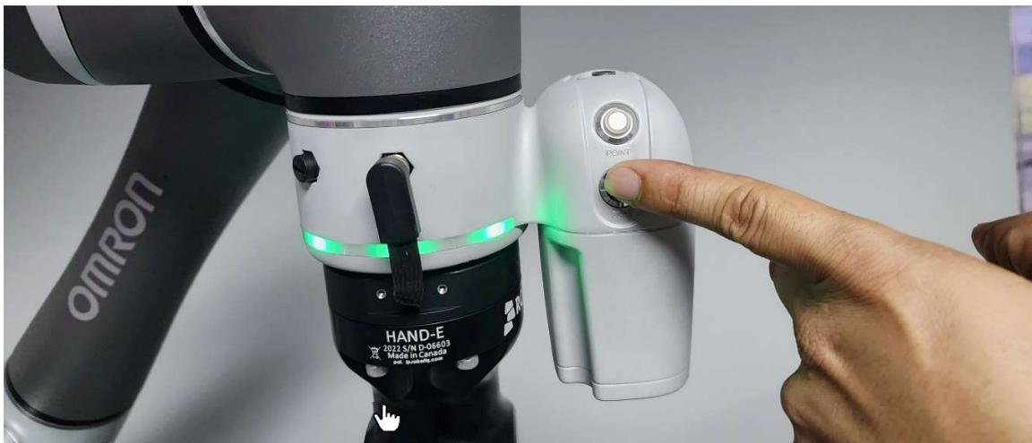
13. Mientras presiona el botón "FREE" puede mover el brazo libremente, coloque el brazo a una posición similar al de la siguiente foto (Posición de inicio).
