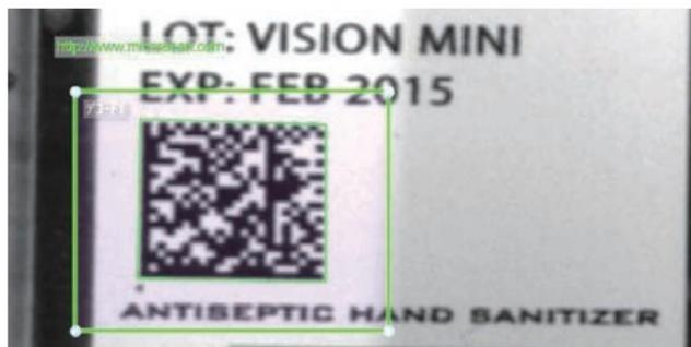
Lee un código de barras o código 2D. La función Match String permite que esta cámara inteligente realice una verificación que generalmente se realiza mediante una PC o PLC.
