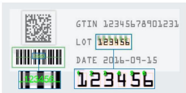
Compara una cadena de caracteres legible por humanos leída por OCR con los datos contenidos en el código leído por CR, lo cual se realiza principalmente mediante una PC o PLC.
