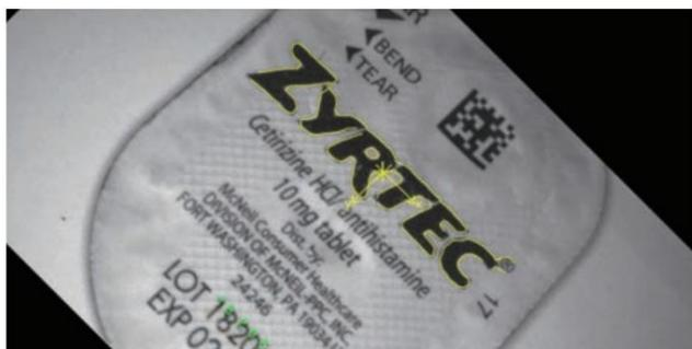
Genera la posición y el ángulo de la imagen registrada. El área de inspección de esta herramienta se puede utilizar automáticamente para el procesamiento posterior a esta herramienta.
