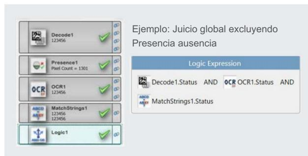
Realiza operaciones lógicas y compara tamaños de resultados de herramientas. La operación lógica del "estado" de cada herramienta se puede utilizar para crear condiciones de juicio individuales en lugar de la condición general.
