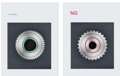
Inspección de orientación del caucho adherido.
