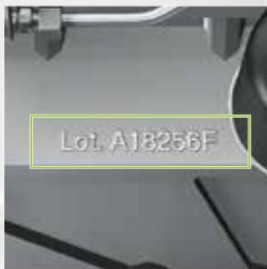
Inspección de presencia de caracteres marcados.
